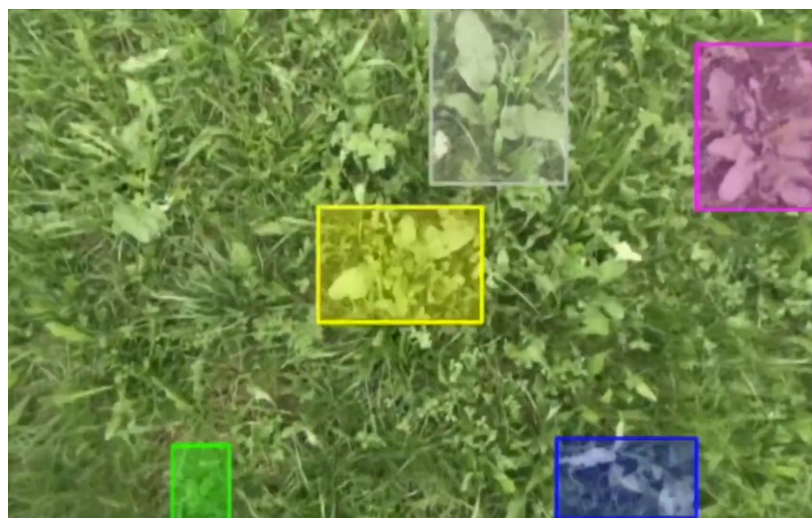
Foto 6: Detail beeldherkenning van ongewenste begroeiing die wordt bespoten.
