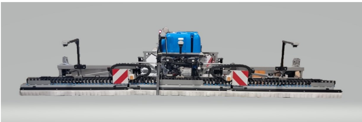
Foto 2: Rumex RXF900 Spotsprayer met geheel omsloten overkapping.
