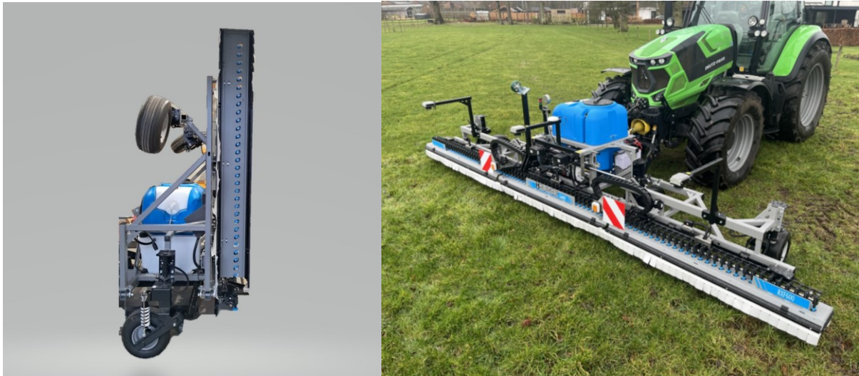
Foto's 3 en 4: Rumex RXF600; op de linkerfoto is de onderkant van de aluminium overkapping met nauwe uitsparingen voor de dopmoeren zichtbaar.
