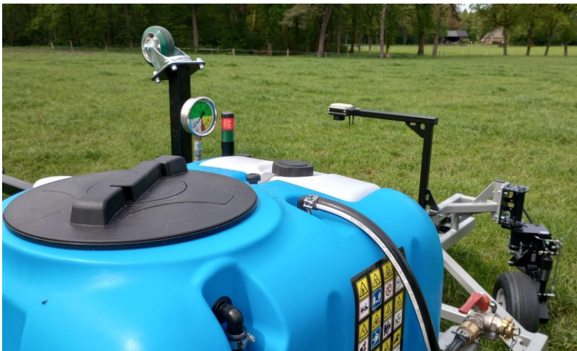
Foto 5: De manometer bevindt zich boven de tank in het zicht van de chauffeur.
