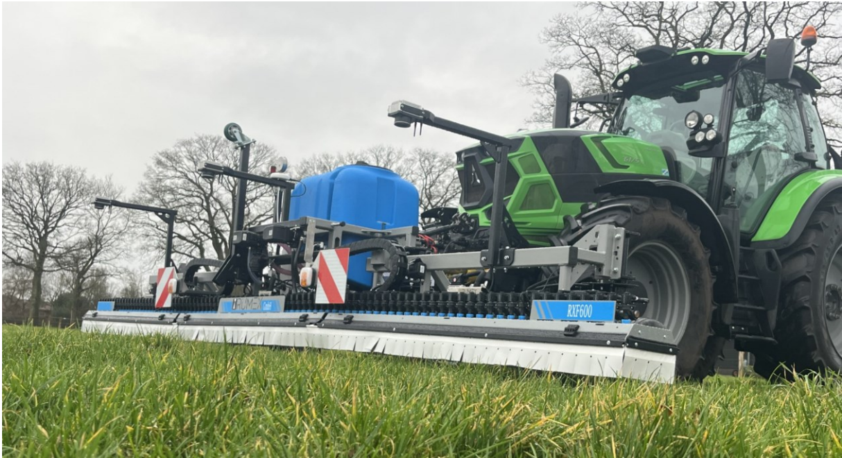
Foto 1: Rumex RXF600 Spotsprayer met geheel omsloten overkapping.
